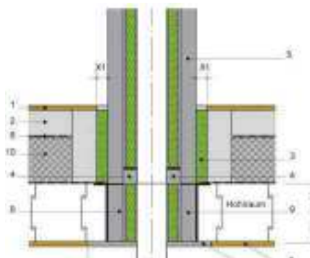
Schacht bei heruntergehängter Decke
