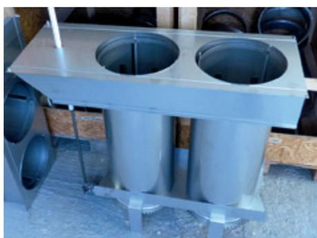
Doppelrohr-Abscheider mit Käfigabstreifer
